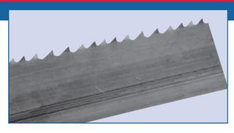
O exemplo mostra desgaste de um lado da lâmina próximo a área do dorso.
