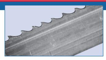
Quebra das partes e cantos dos dentes em grande parte da extensão da lâmina.
