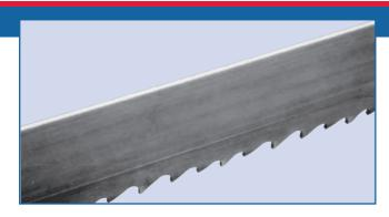
O desgaste excessivo nas costas da lâmina apresenta uma aparência polida ou estrias anormais junto a superfície. Deformações dos cantos podem ocorrer simultaneamente.
