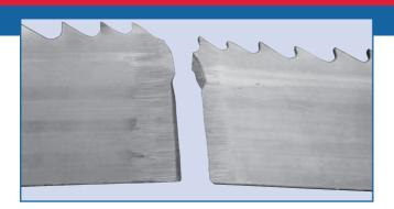
Para se constatar que uma lâmina quebrou na solda, inspeciona-se ambos os lados da quebra para ver se existem marcas provenientes do processo de acabamento da solda.
