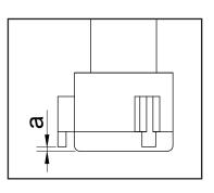
Distância "a" entre a ponta e a tampa do cabeçote de 1,5mm (para capacidades de 6-12mm) e de 0,5mm (para as demais capacidades), possibilitando a medição na maioria dos "furos cegos"
